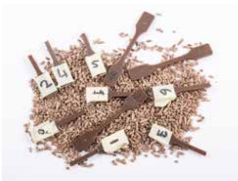
Jute-PLA granulaat en daarvan gemaakte trekstaafjes, ter bepaling van de treksterkte
