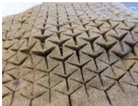
Resultaat van het met een lasersnijder bewerken van een biocomposit
